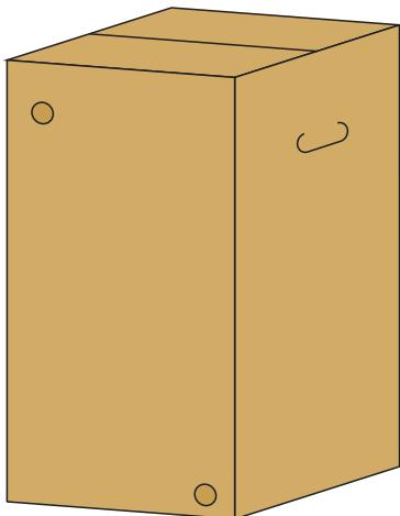
**Короб под кегу** разработан для хранения и транспортировки пластикового контейнера типа "ПЭТ-кег" от 20л. Имеет вентиляционные отверстия и ручки.
