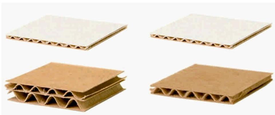
**Трехслойный гофрокартон (Т)** состоит из одного гофрированного слоя и двух наружных плоских слоев картона. Этот и последующие виды картона жесткие и изготавливаются только в листах. Трехслойный гофрированный картон преимущественно применяется для изготовления тарных коробок и вкладышей.
