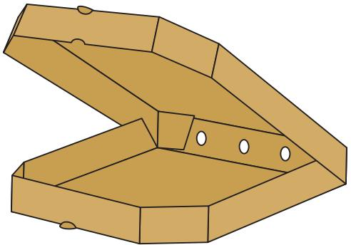
**Лоток под пиццу** чаще всего создают из микрогофрокартона с применением печати. Полиграфический рисунок наносится т с помощью флексопечати. Благодаря своей конструкции, лоток легко и быстро собирается. Изготавливается чаще из 3-х-слойного микрогофрокартона. Может иметь различную, форму и размер в зависимости от потребности клиента.
