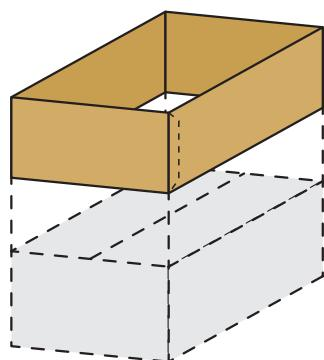
**Гофропрокладка (дно)** – это вспомогательное упаковочное средство в виде листа гофрокартона или картона, используемое для усиления дна или крышки гофроящика или коробки и разделения упаковываемой продукции. В таком случае нагрузка распределяется равномерно, а транспортный пакет приобретает устойчивость при складировании, хранении и перевозке.
