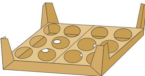
**Гофролоток под стакан** - лоток прямоугольной ормы для молочной продукции в пластиково стакане. Предназначен под сборку на линии автомат. При изготовлении данного вида упаковки особое внимание уделяется соответствуя размеров, поскольку отклонения геометрии изделия (свыше 2-4 мм) значительно влияют на работу упаковочной линии.
